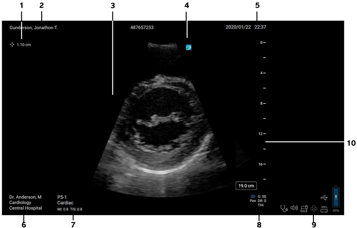
**Bild 1 Layout för klinisk monitor**
