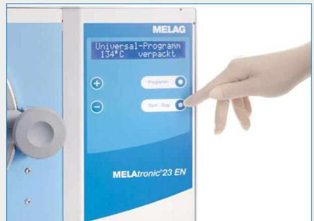
Der MELAtronic®23 EN verfügt über vier Sterilisationsprogramme. Im Universalprogramm und im Prionenprogramm (beide 134 °C) können kleinere Mengen massive, verpackte Instrumente sterilisiert werden. Im Schnellprogramm (134 °C) können unverpackte Instrumente und im Schonprogramm können bei einer niedrigeren Temperatur von 121 °C temperaturempfindliche, massive Instrumente (unverpackt) sterilisiert werden.
