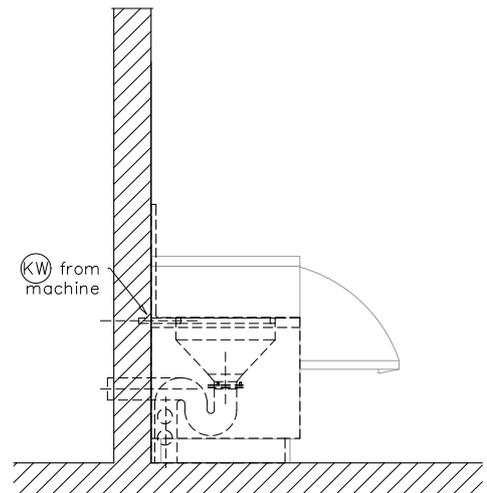
Konfiguration mit Ausgussbecken und Frischwasseranschluss
