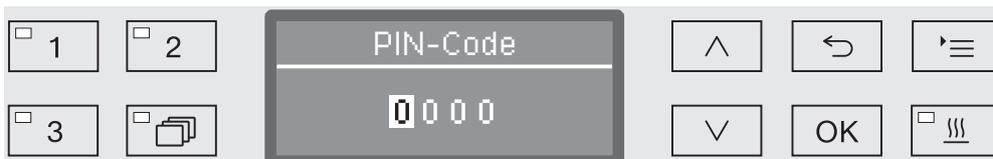
Falls Sie nicht über den PIN-Code verfügen, wenden Sie sich bitte an einen Anwender mit entsprechenden Zugriffsrechten oder brechen Sie den Vorgang mit der Taste ↶ ab.
