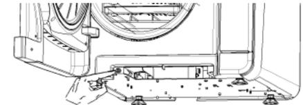
**6** Schieben Sie den Staubfilter zurück in seine Ausgangsposition.
