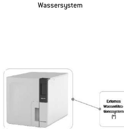
**Info (\*):** Das Wasserfiltrationssystem muss mit einem Rückflussverhinderer ausgestattet sein, der der IEC 61770 und den nationalen und lokalen Vorschriften entspricht.
