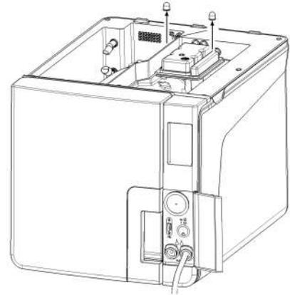
**8** Entfernen Sie den Ablassschlauch.
